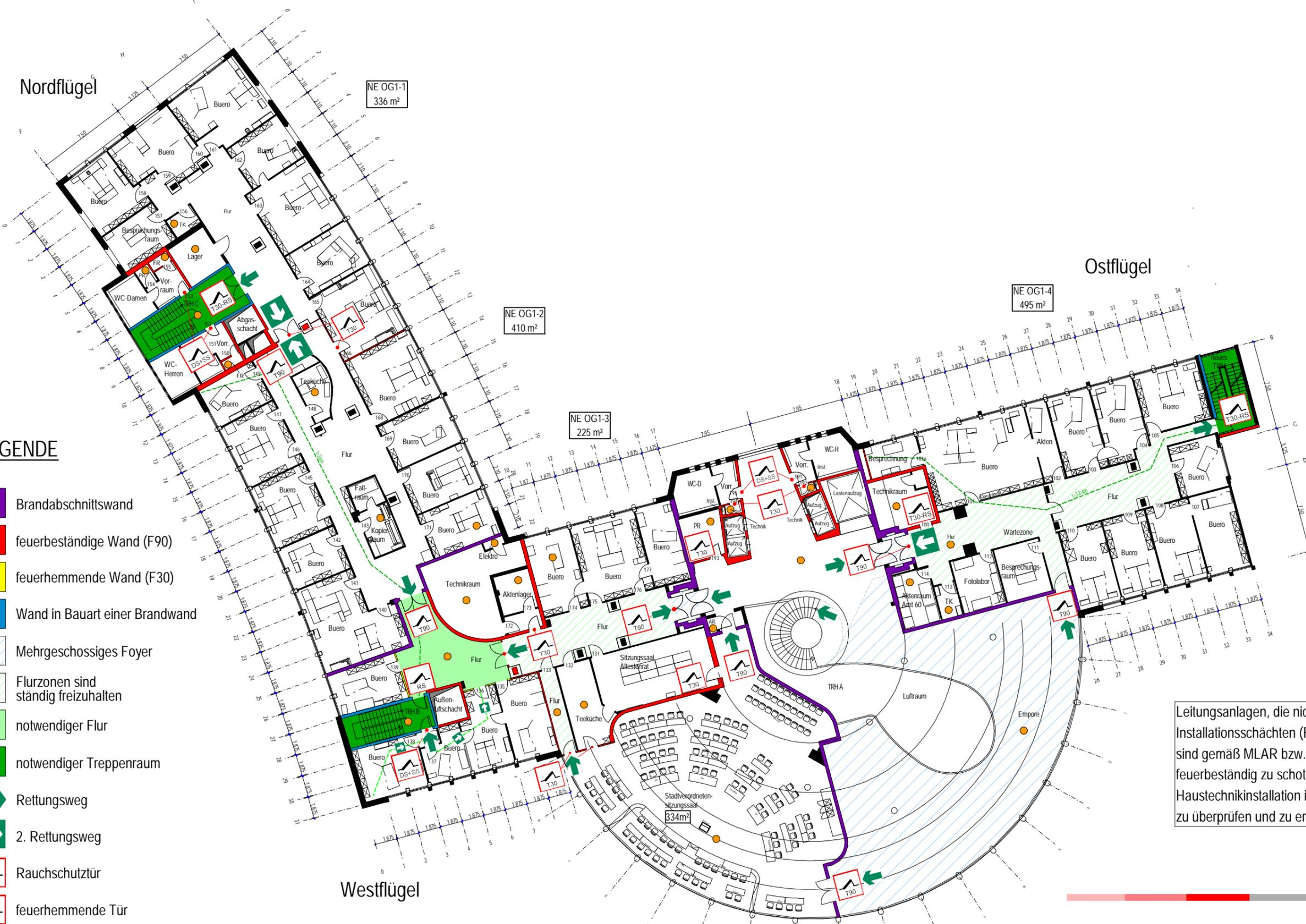
Leitungsanlagen, die nicht in qualifizierten Installationsschächten (F90) geführt sind, sind gemäß MLAR bzw. M-LüAR in Deckenebene feuerbeständig zu schotten. Die vorhandene Haustechnikinstallation ist entsprechend zu überprüfen und zu ertüchtigen.
