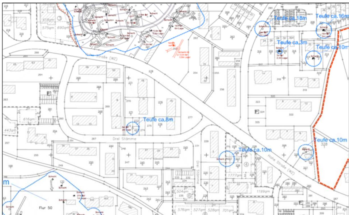
**Abb. 4:** Lageplan ehemaliger Tagebau und untertägige Situation sowie Bergsenkungsgebiete (Quelle: Herbert Mathes & Söhne, Bergtechnisches Vermessungsbüro, Stand: 31.07.2015)
