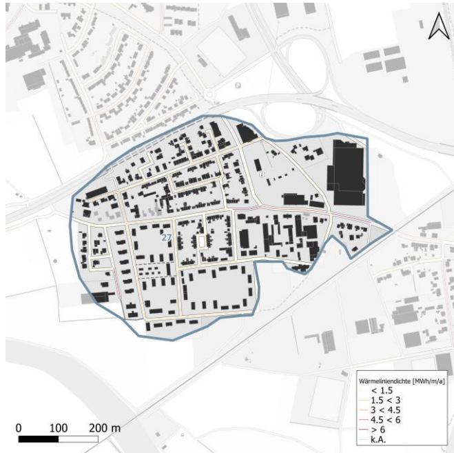
Wärmeliniedichte (Indikator für Wärmenetz)
