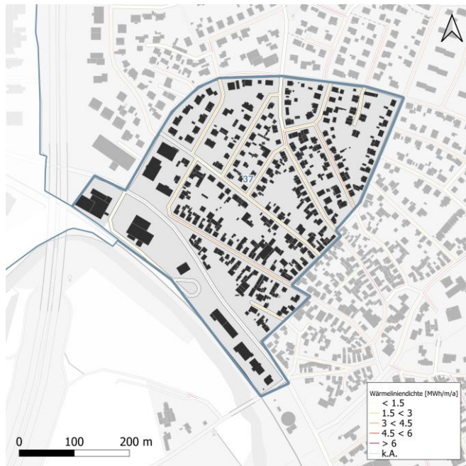
Wärmeliniedichte (Indikator für Wärmenetz)
