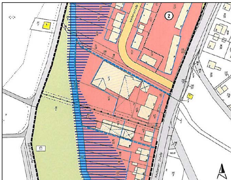
Abb. 2: Ausschnitt aus dem Bebauungsplan Nr. 259. Die blauen Strichel-Linien kennzeichnen den Bereich der 1. Änderung. Die blaue Schraffur zeigt die Lage des Überschwemmungsgebietes des Wetzbaches.
