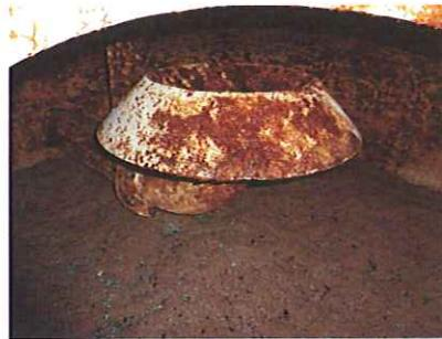
**Bild 32 + 33:**      **Starker Korrosionsbefall des Stahlfiltermantels
