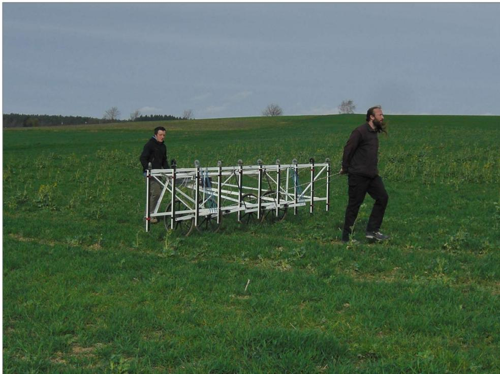
Abbildung I414-2: Magnetisches Messsystem LEA MAX mit 10 Fluxgate-Gradientensonden
