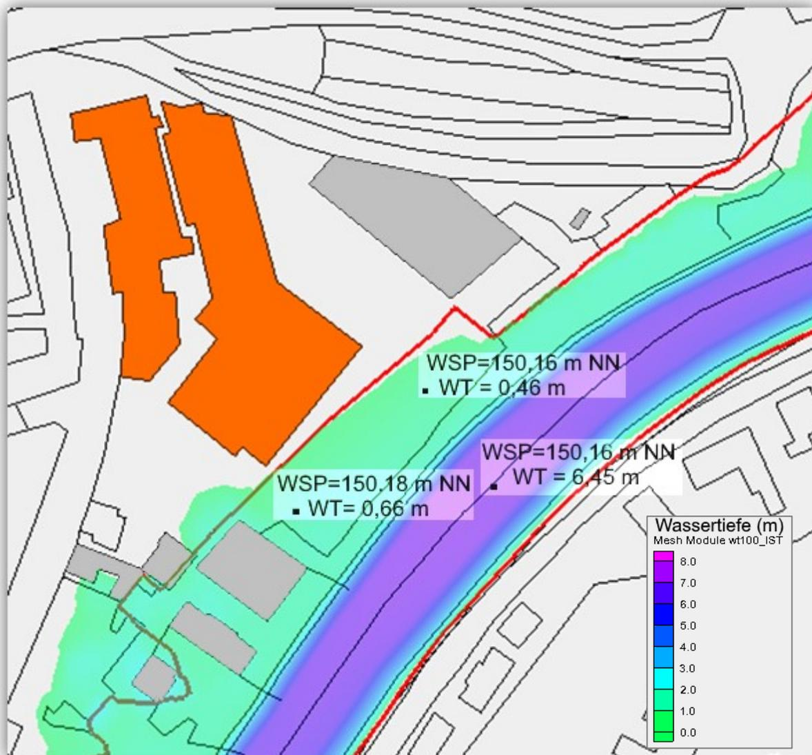
Abbildung 9: HQ<sub>100</sub>-Überschwemmungsgebiet der Lahn - IST-Zustand aus 2D-Modell Bereich Lahnhof
