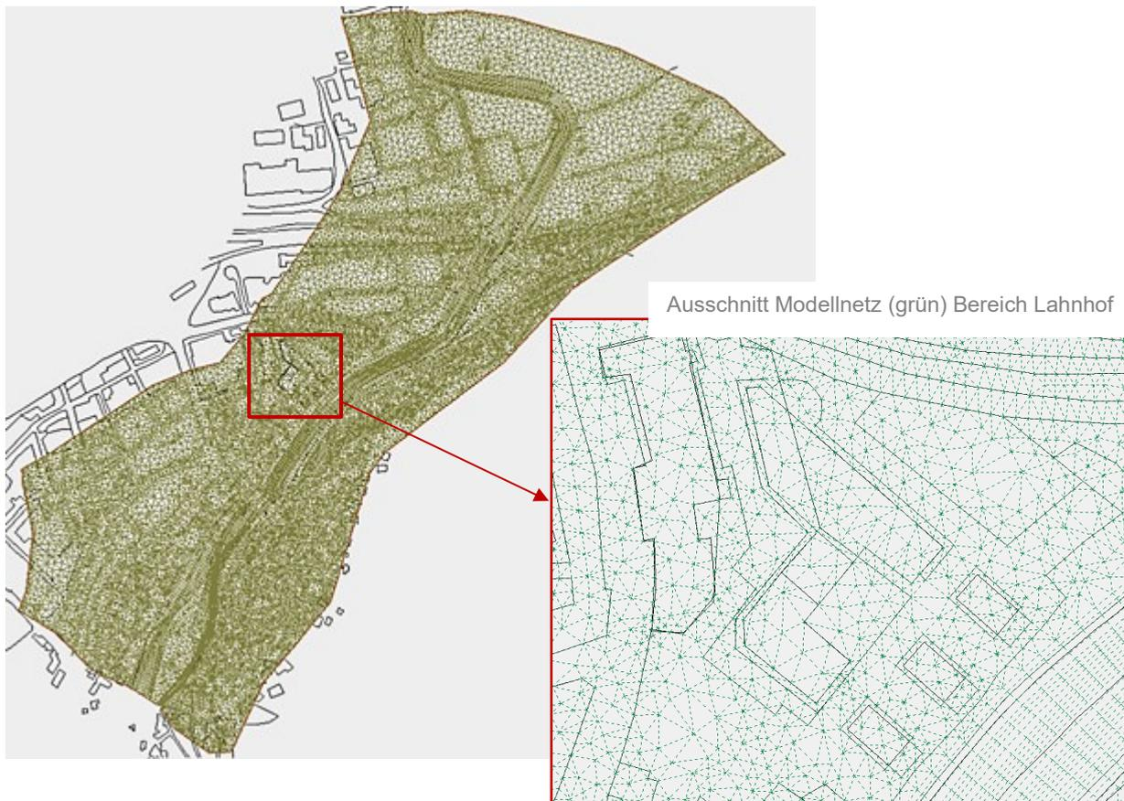
**Abbildung 7: Netzstruktur des Simulationsmodells „Lahnhof Wetzlar“**
