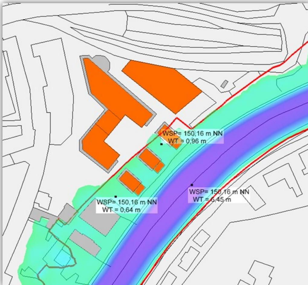
Abbildung 13: HQ<sub>100</sub>-Überschwemmungsgebiet der Lahn - PLAN-Zustand mit Retentionsraumausgleich
